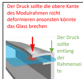
Abbildung 1a: Druck auf die Klemmenstellen
